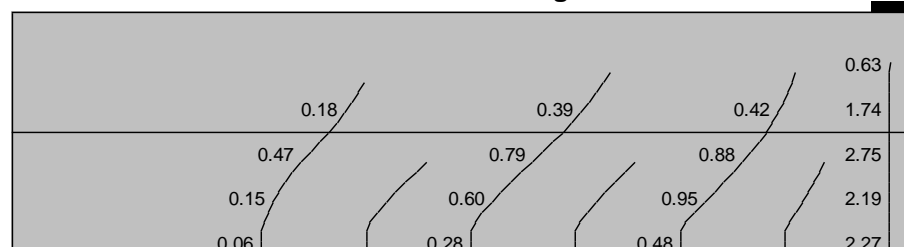
Gambar 8 Pola retak balok T15 bentang 4m
