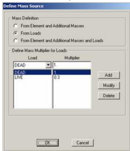
Gambar 3.41 Kotak dialog Define mass source
