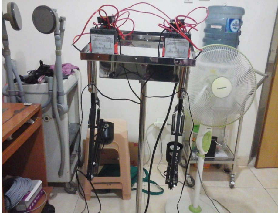
2. Gambar alarm alat terapi infra merah dengan sensor suhu
