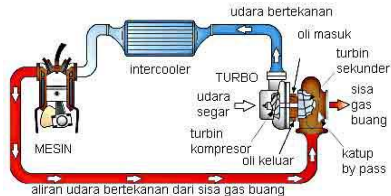
Gambar 2. 6 sistim Turbocharger pada sebuah mesin
