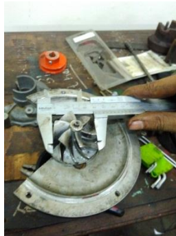
Gambar 4. 14 Pemeriksaan Compressor Impeller
