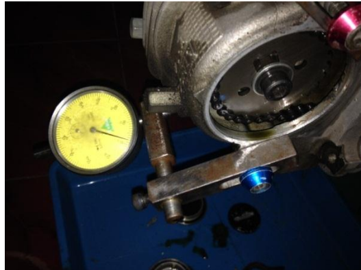
Gambar 3.20. Dial Indikator pada Katup Buang
