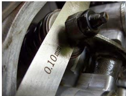
Gambar 3.14. Pengukuran Celah Katup
