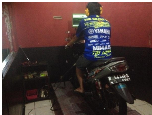
Gambar 3.23. Pengujian Sepeda Motor pada Dinamometer.
