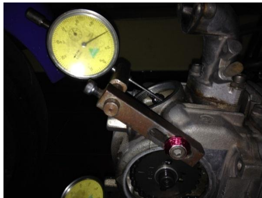
Gambar 3.16. Pemasangan Dial Indikator
