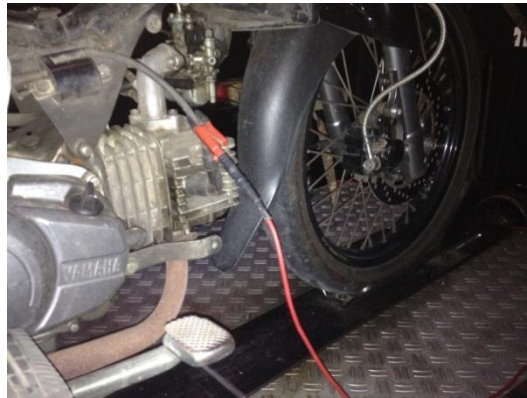
Gambar 3.22. kabel sensor putaran mesin.
