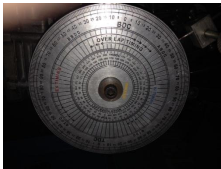
Gambar 3.17. Posisi Jarum Busur Derajat pada 41,5^\circ .
