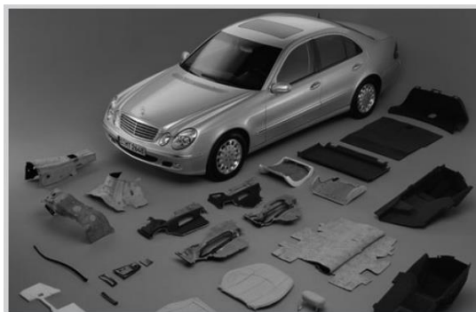
Gambar 1. Komponen mobil Mercedes-Benz E Class yang menggunakan serat alam sebagai material penyusunnya (Holbery & Houston, 2006).
