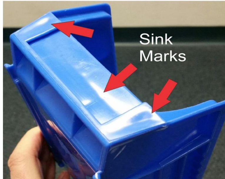
Gambar 2.6 Kecacatan sink mark yang terlihat pada suatu produk plastik (media.licdn.com)
