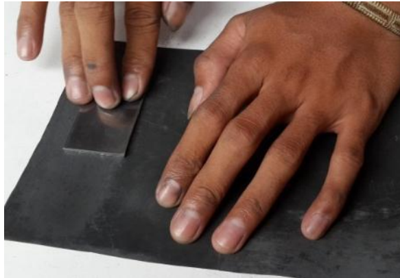
Gambar 3.21 Proses Pengamplasan Spesimen
