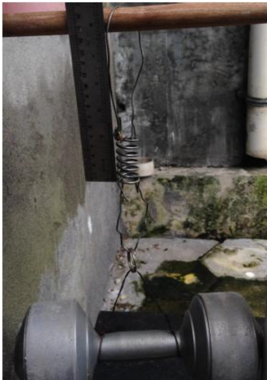
Gambar 11. Pengukuran defleksi pegas saat pembebanan.
