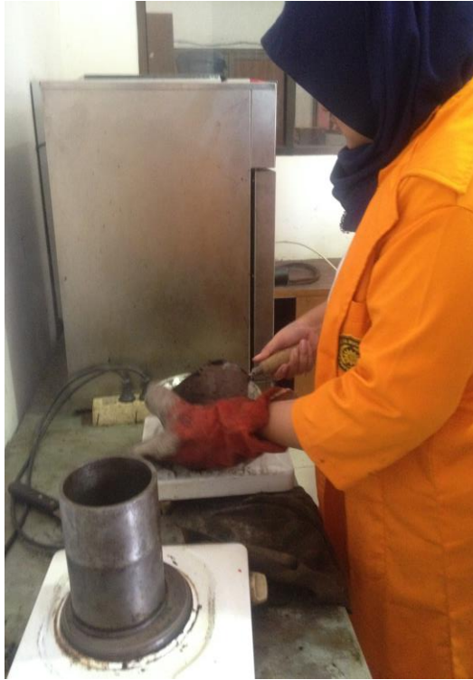
Gambar 7. Alat untuk memasak Agregat dan pemanas silinder cetakan
