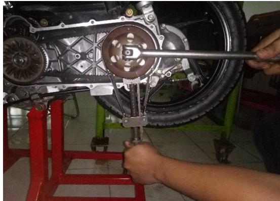
Gambar 3.29 Proses memasang outer clutch
