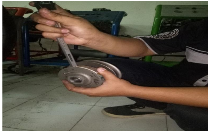
Gambar 3.18 Proses mengukur sepatu kopling
