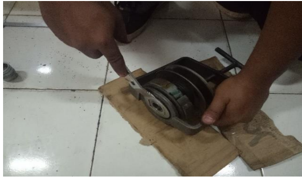
Gambar 3.23 Proses memasang sepatu kopling
