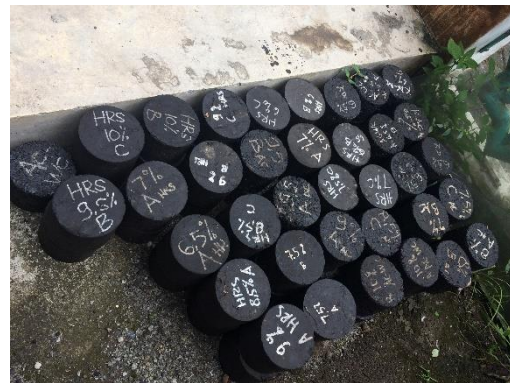
Gambar 26. Benda uji setelah uji Marshall
