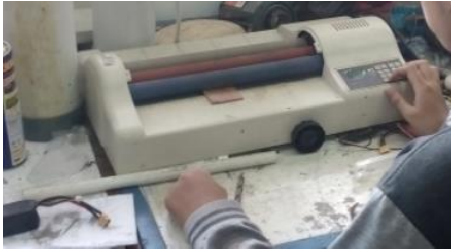
Gambar 3.10 Proses Pemindahan Layout Jalur ke Shield Board .
