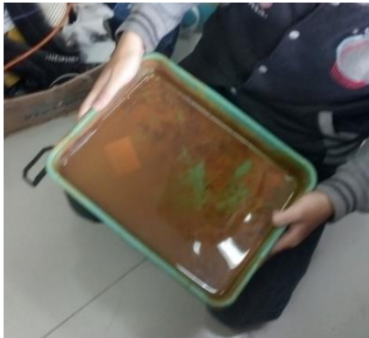
Gambar 3.11 Proses Pelarutan Shield Board Menggunakan Cairan \text{FeCl}_3 .
