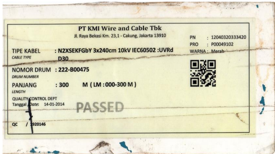
gambar 4.1 Spesifikasi kabel dari Power Plant Menuju substation 80 dan substation II
