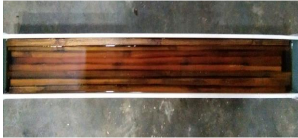
Gambar 4.5 Perlakuan dengan larutan NaOH
