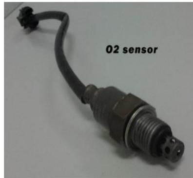
Gambar 2.20 Letak Lubang Masuk Udara Luar pada Sensor (PT. Astra Honda Motor :2014)
