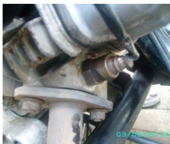
Gambar 2.18 Letak Sensor O<sub>2</sub> (PT. Astra Honda Motor :2014)
