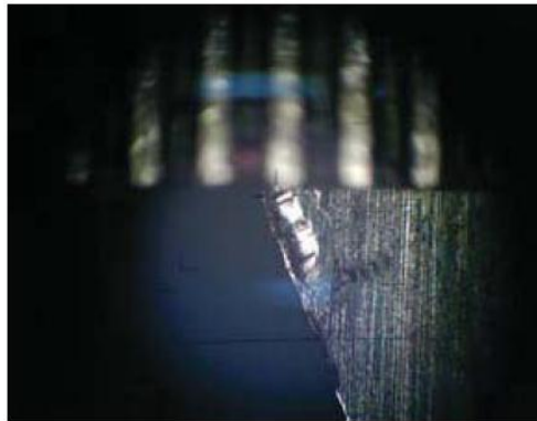
Gambar 2.4 Bentuk sudut potong setelah mengalami keausan
