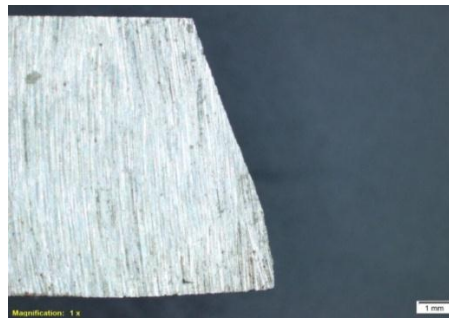
Gambar 4.1 Foto ujung pahat High speed steels (HSS) sebelum terjadi keausan pahat
