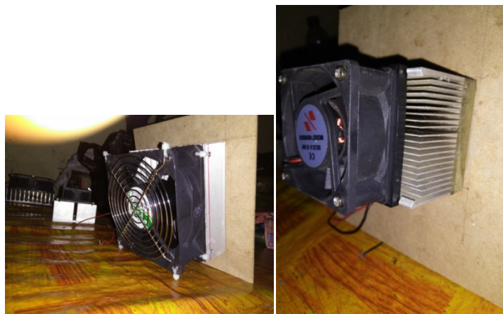
Gambar 3.11 Pemasangan kipas pada Heat sink sisi panas (kiri) dan Heat sink sisi dingin (kanan)
