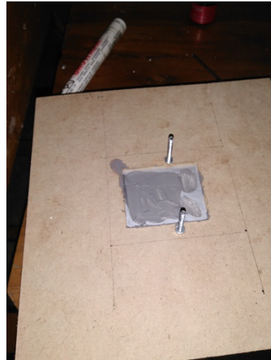
Gambar 3.10 Pemeberian Thermal Grease
