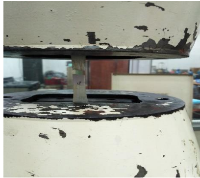
Gambar 3.30 Perpatahan saat Uji Tarik
