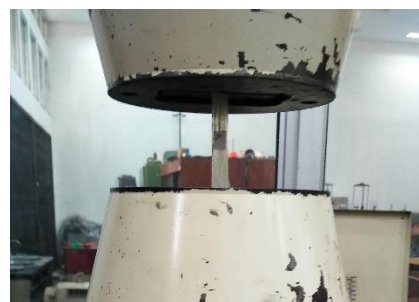
Gambar 3.29 Pemasangan Spesimen Uji
