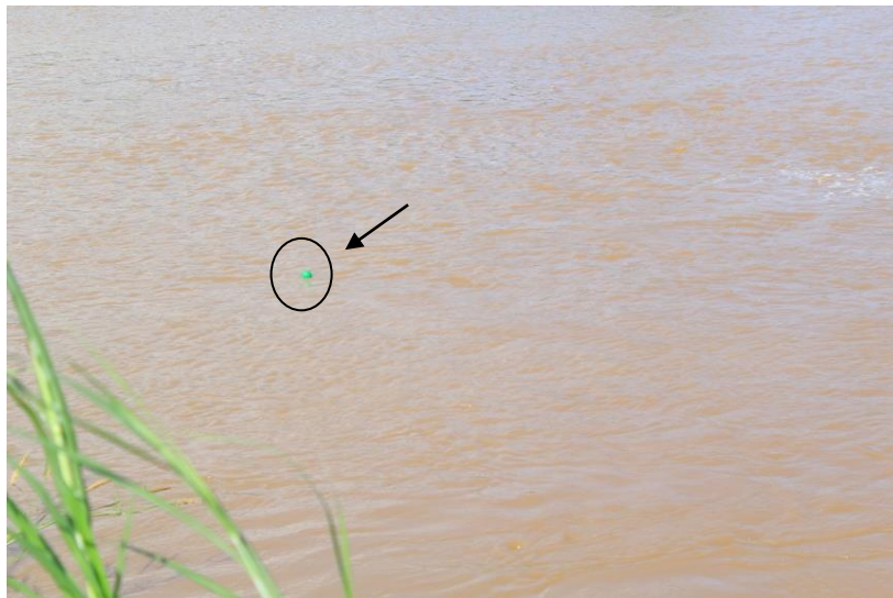
Gambar 4.20 Pengukuran kecepatan dengan bola
