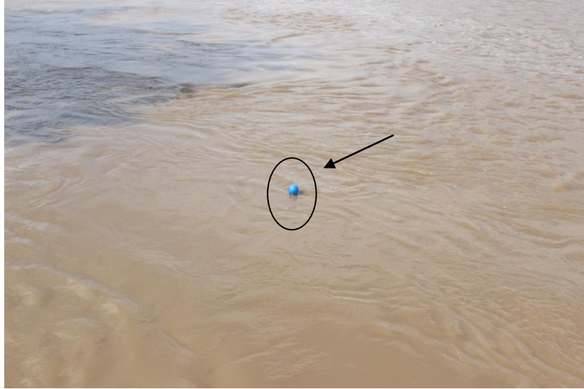
Gambar 4.23 Pengukuran kecepatan dengan bola
