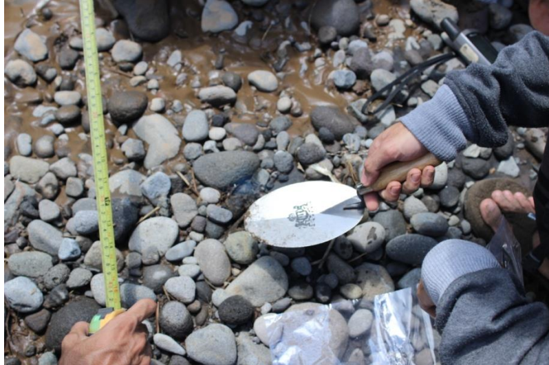
Gambar 4.19 Pengambilan sampel sedimen di pinggir sungai bagian hilir sapon
