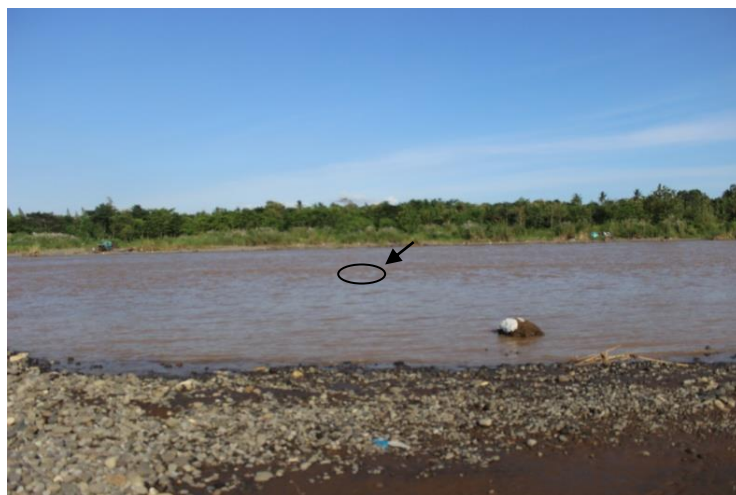
Gambar 4.26 Pengukuran kecepatan dengan bola
