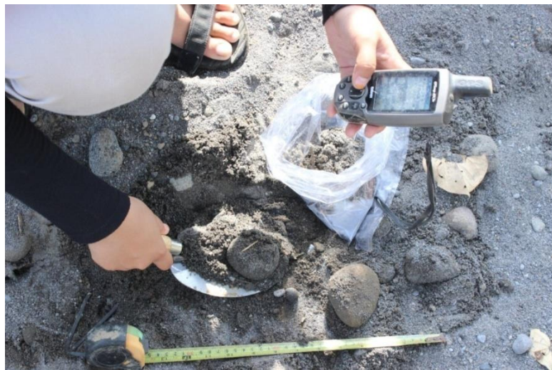
Gambar 4.22 Pengambilan sampel sedimen di pinggir sungai Hulu Srandakan
