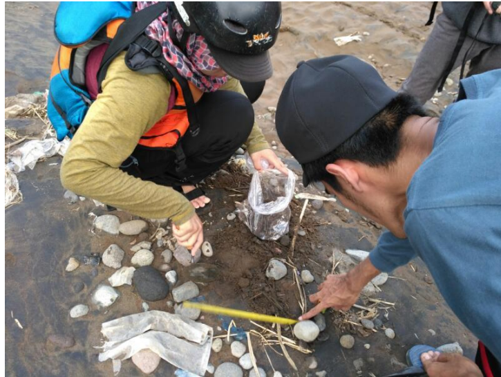
Gambar 4.25 Pengambilan sampel sedimen di pinggir sungai bagian Hilir Srandakan
