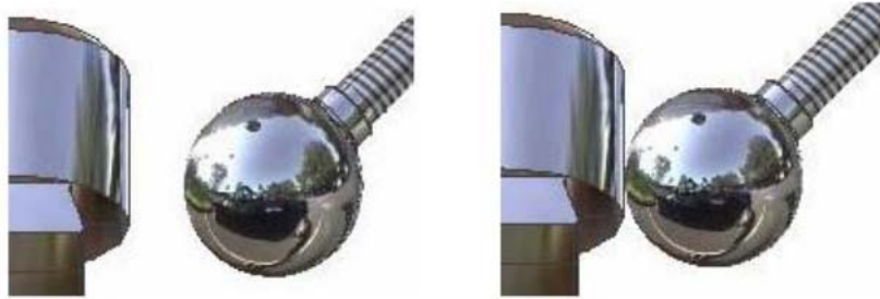
Gambar 5.6 Penggunaan Tangent Constraint dengan Solusi Inside
