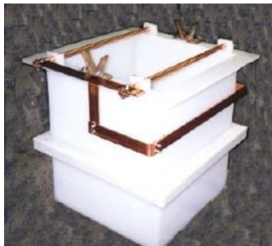
Gambar 3.1 Bak untuk proses elektroplating
