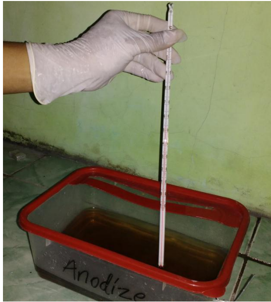
Gambar 3.24. Pengukuran Suhu (tercatat 29°C-55°C).
