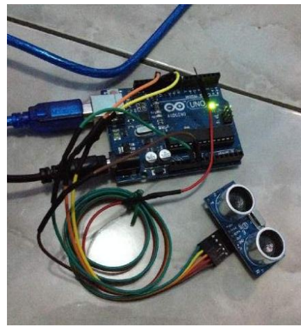
Gambar 3.6 Rangkaian Jadi Arduino & Sensor Ultrasonik
