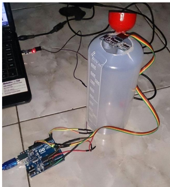
Gambar 3.7 Simulasi Pengukuran Bahan Bakar Minyak Dalam Tangki Pendam
