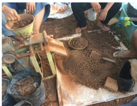
a. Proses penggilingan tanah mediteran
