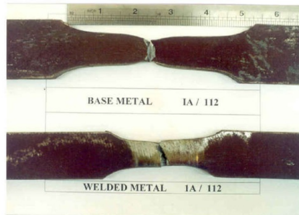
GAMBAR 6. Patahan Hasil pengujian tarik
