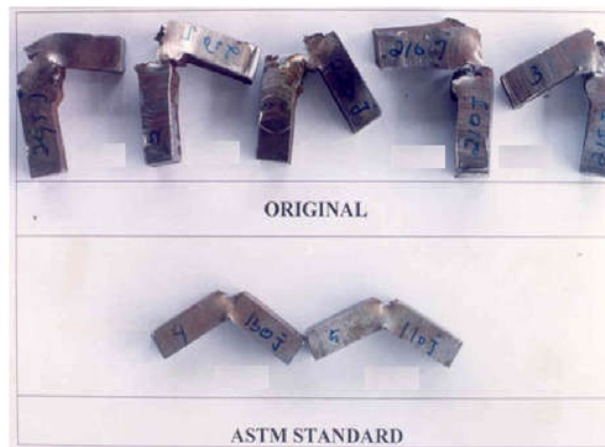
GAMBAR 8. Patahan hasil pengujian impact
