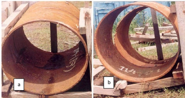
GAMBAR 2. (a) Sampel tiang pancang yang tidak rusak, (b) sampel tiang pancang yang patah
