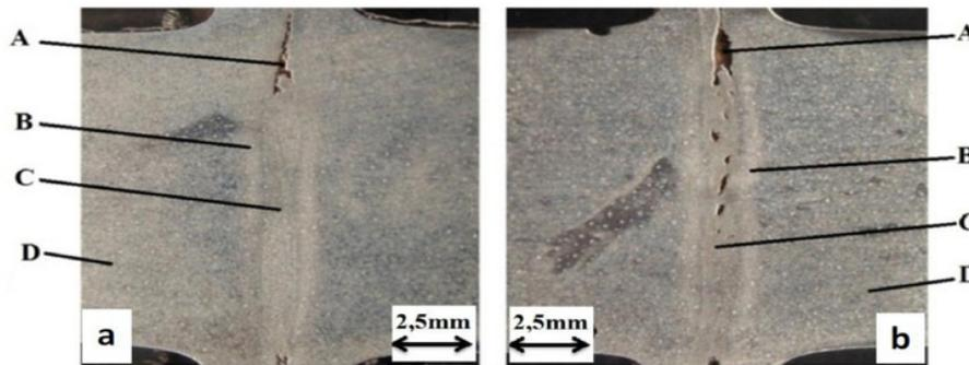
GAMBAR 4. Struktur makro daerah sambungan las pada pengelasan pengelasan gesek: (a) benda uji dengan tekanan tempa tekanan 8,27 MPa dan tekanan gesek 2,76 MPa, (b) benda uji dengan tekanan tempa 6,90MPa dan tekanan gesek 2,07
