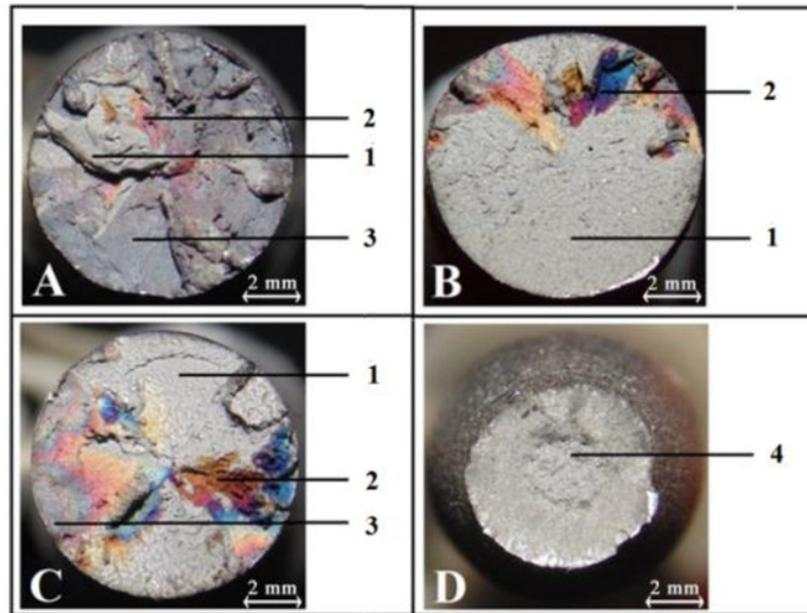
GAMBAR 8. Penampang patah spesimen hasil uji tarik dengan kekuatan tarik (A) terendah, (B) tinggi, (C) sedang, (D) *base metal* (tanpa sambungan)
