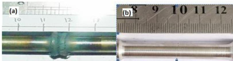
GAMBAR2. (a). Hasil pengelasan gesek baja tahan karat austenitik AISI 304 (b) pembubutan spesimen uji tarik sesuai standar *ASTM A 370-07a*
