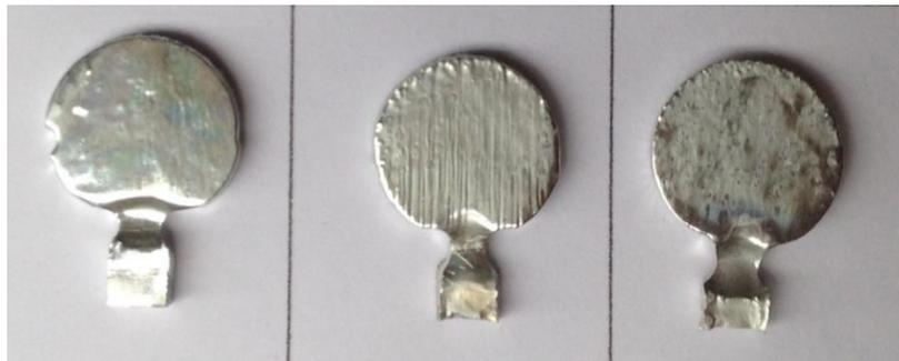
Gambar 4.1 Kegagalan dari proses *anodizing* aluminium seri 1XXX.
