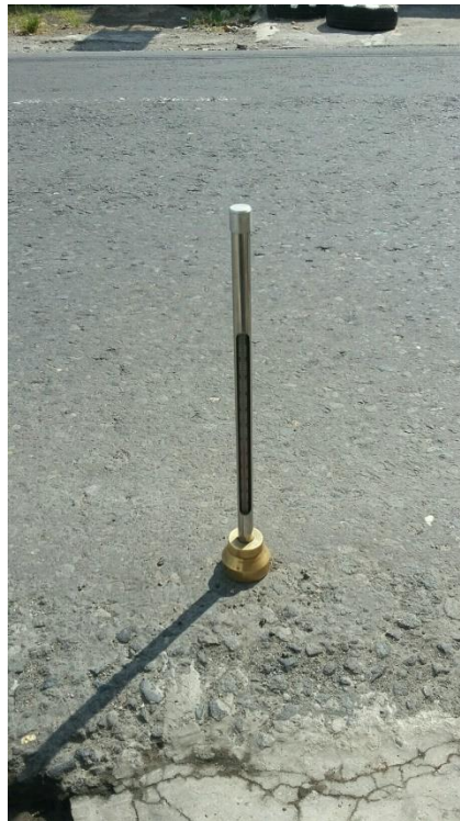
Thermometer pengukur suhu udara dan temperatur perkarasan
