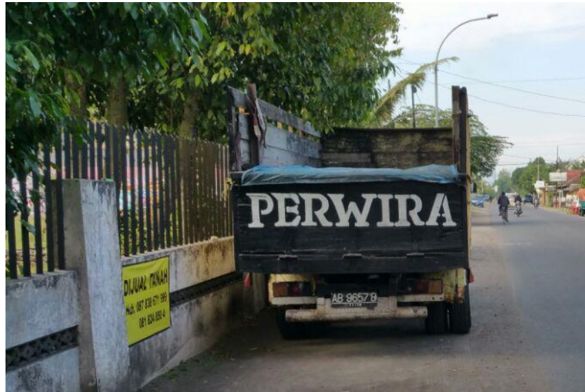
Truk penguji dengan berat total 11.3 ton
