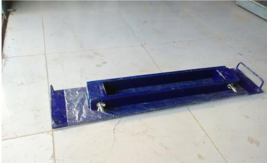
Gambar 3.3 Cetakan benda uji
