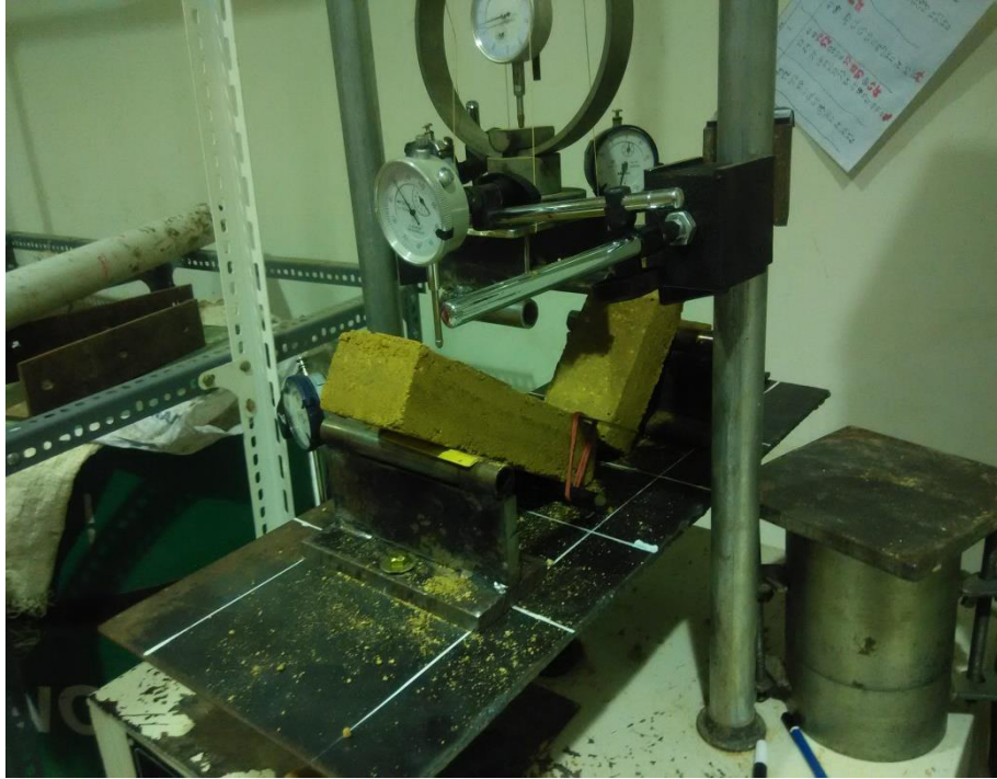
Gambar 5 Benda uji patah ketika diuji
