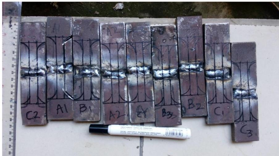
**Gambar 4. 1 . Spesimen Baja SS-400 setelah proses *pembentukan sudut* dan sesudah dilakukan pengelasan, (a) *pengelasan* dengan variasi waktu 5 detik, (b) *pengelasan* dengan variasi waktu 7 detik, (c) *pengelasan* dengan variasi waktu 10 detik.**
