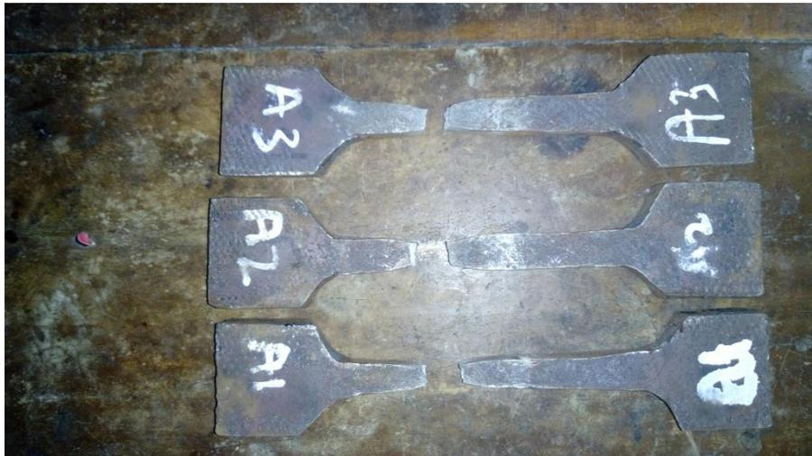
**Gambar 4. 2 Spesimen Yang Patah Setelah di Uji**
