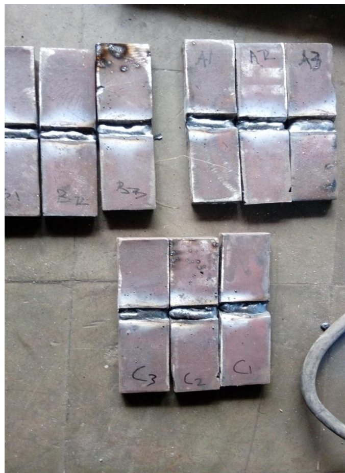
Gb. setelah di bentuk untuk pengujian tarik
