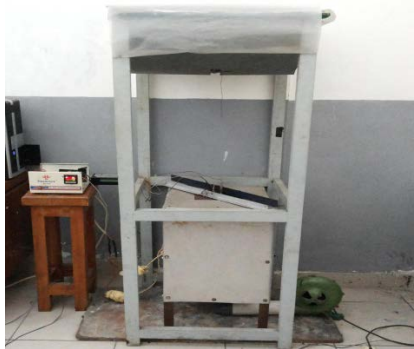
Gambar 3.2 Tungku pemanas ( Furnace )
