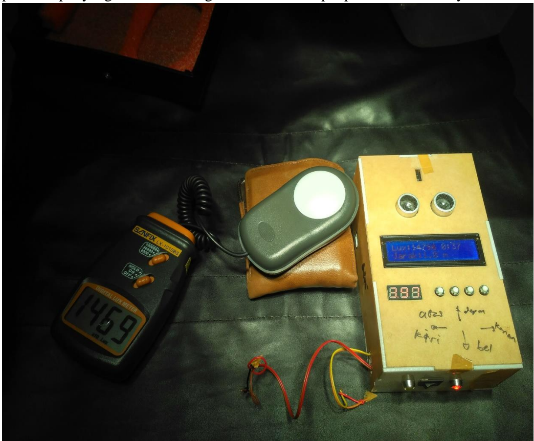
Pengambilan data intensitas cahaya lampu operasi pada jarak 1 meter
