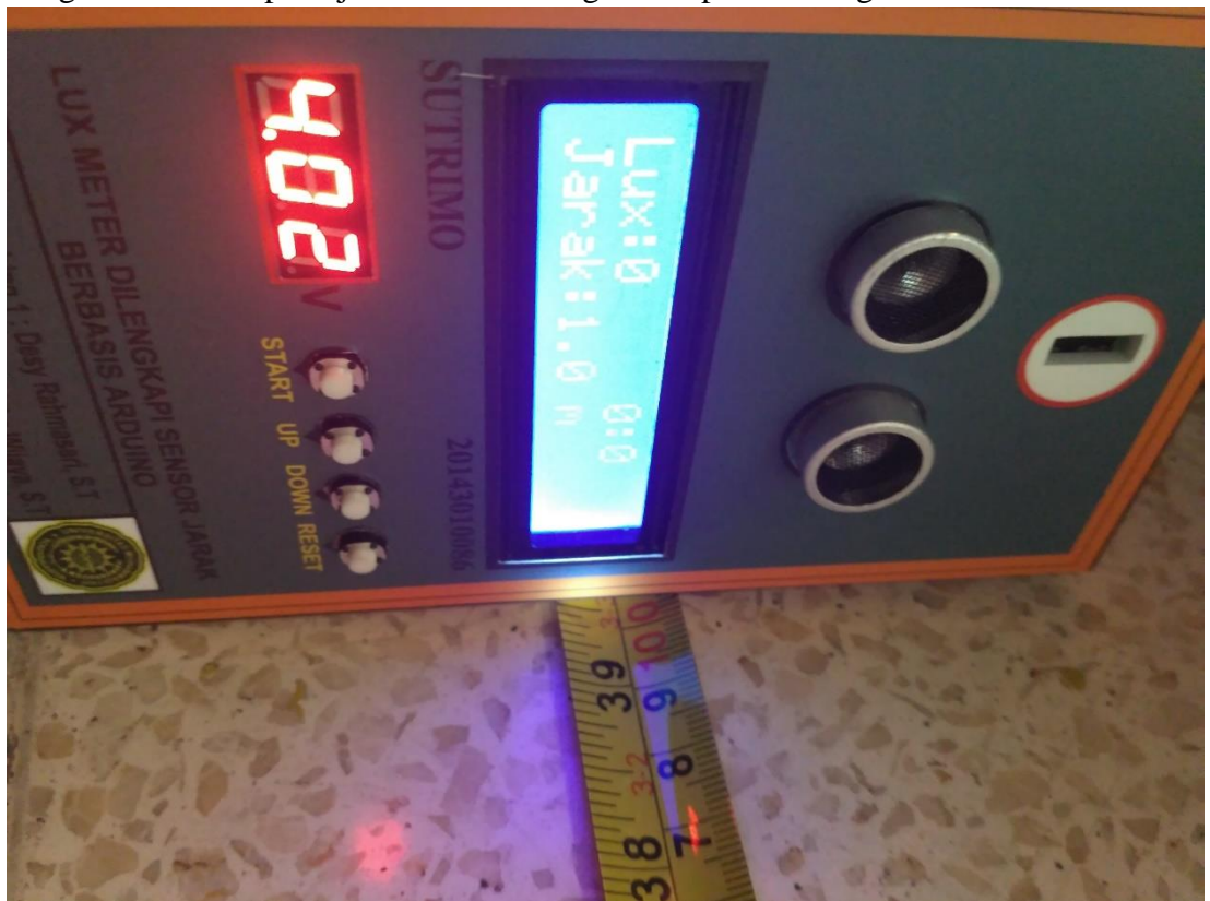
Pengambilan data pada jarak 1 meter dengan alat pembanding meteran
