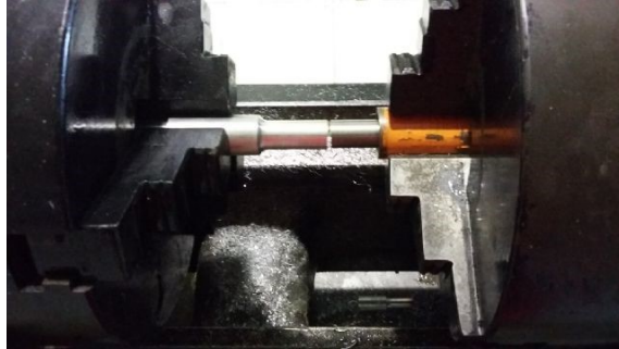
Gambar 3.13. Pemasangan bahan diposisikan center.
