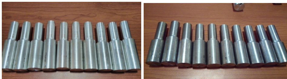
Gambar 3.12. Hasil pembuatan spesimen bahan aluminium dan stainless yang sudah dibuat standar JIS Z 2201.
