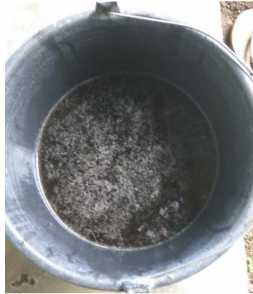
Gambar 3.17. Proses perendaman dengan alkali
