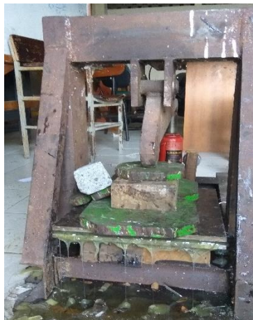
Gambar 3.25. Pengepresan dengan menggunakan dongkrak
