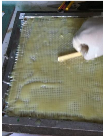
Gambar 3.24. Proses pembasahan serat gelas
