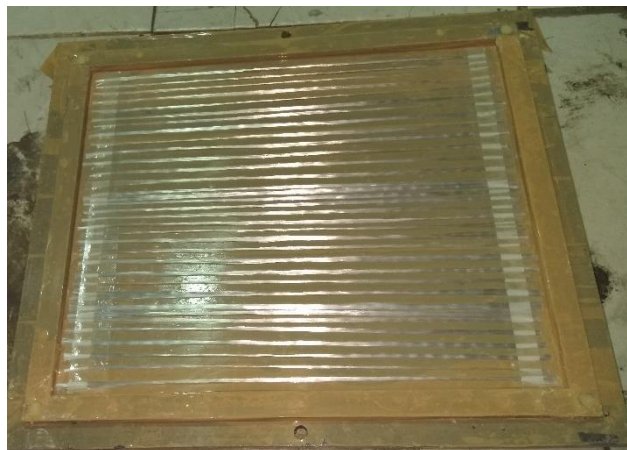
Gambar 3.22. Susunan serat gelas searah
