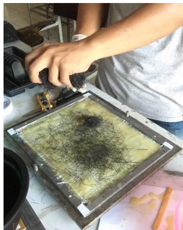
Gambar 3.23. Proses penaburan serat ijuk acak
