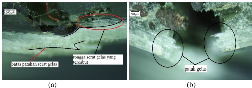
Gambar 4.11. Foto patahan serat gelas (a). Pada spesimen L/d = 24 hybrid ratio ( r_h ) 0,4; (b). Pada spesimen L/d = 32 hybrid ratio ( r_h ) 0,4
