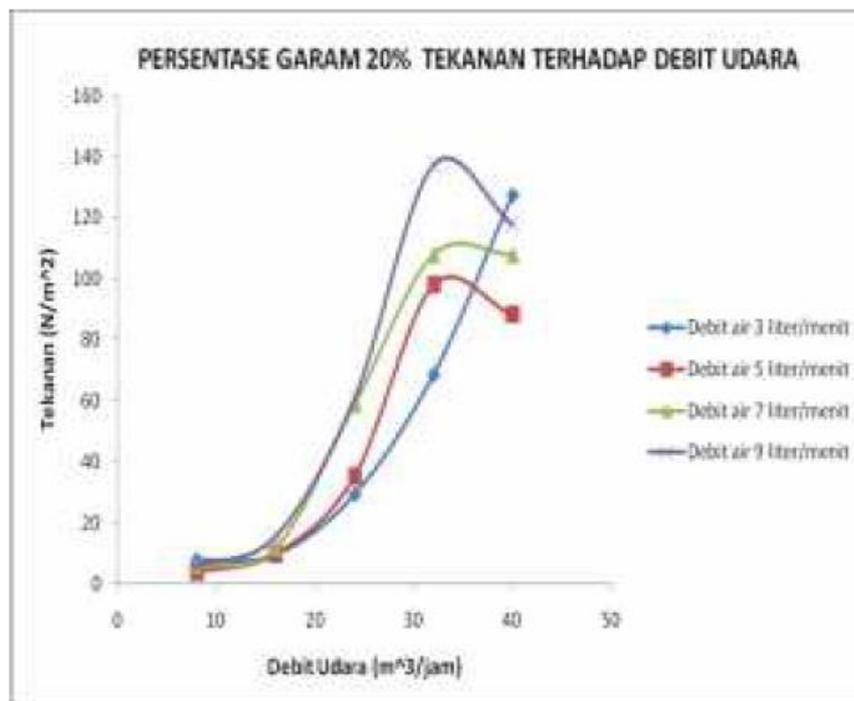
**Gambar 2.15.** Hubungan tekanan diferensial terhadap debit udara pada konsentrasi larutan garam 20% (Widodo, 2015).
