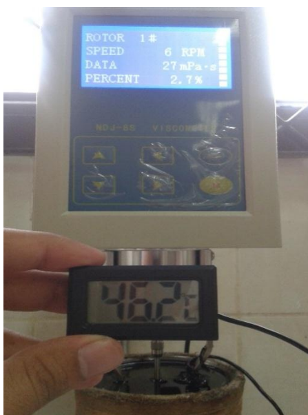
Pengujian viskositas dengan variasi temperatur suhu
