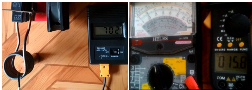
Gambar 4. 11 Hasil pembacaan alat ukur pengujian alat preheat terhadap spesimen uji stainless steel
