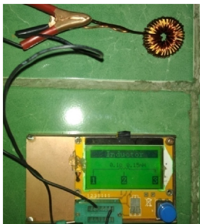
Gambar 4. 8 Pembuatan induktor dengan LCR meter
