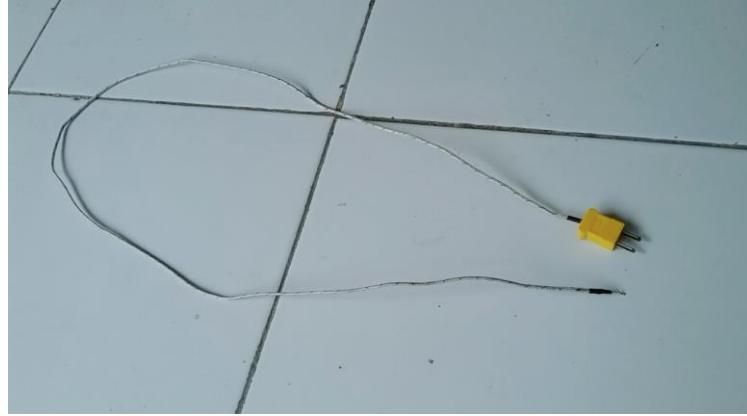
Gambar 3.11 *Termocouple tipe-K*
