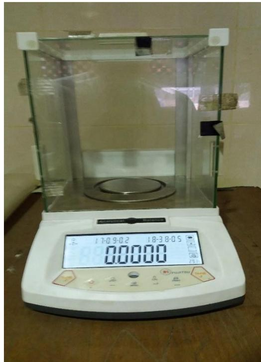
Gambar 3.7 Timbangan digital tipe FS-AR 210
