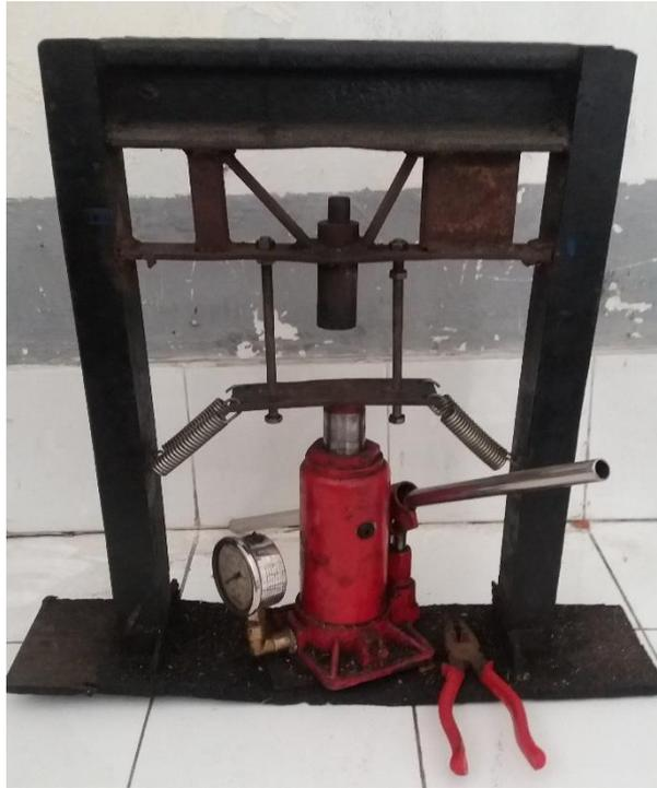
Gambar 3.16 Alat pengepres briket
