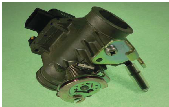
Gambar 2.10 Konstruksi throttle body (Jama, 2008)
