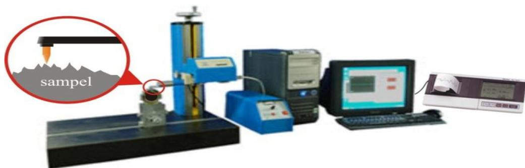
**Gambar 2.9** Skema *stylus* membaca permukaan sampel (Hidayat 2013)
