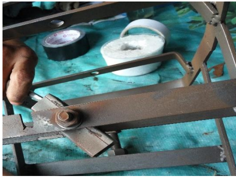
Proses mengubah ukuran sudut holder box shot peening
