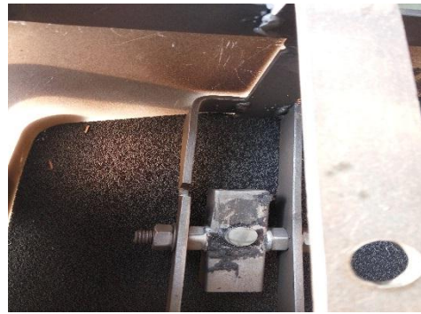
Proses pemasangan sampel dalam box shot peening
