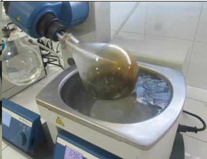
n. Filtrat daun pepaya dievaporasi dalam rotary evaporator dengan suhu 6,9-7^{\circ}\text{C}
