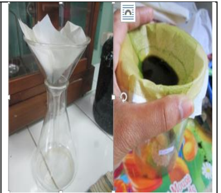
l. Penyaringan filtrate dengan kertas saring dan corong buncher
