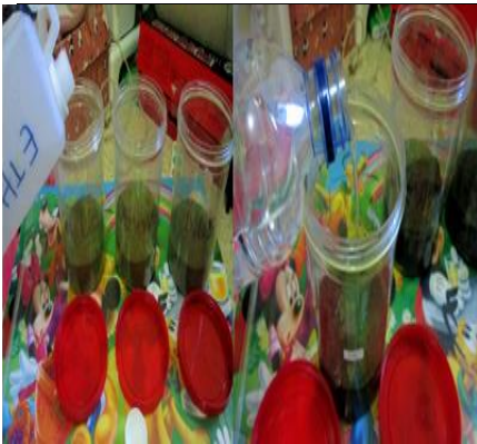
j. Simplisia dilarutkan dengan etanol 96% dan aquadest
