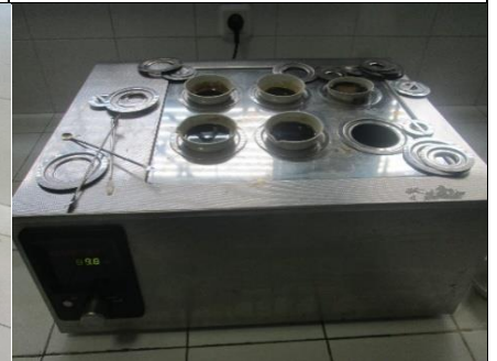
o. Penguapan ekstrak daun pepaya menggunakan water bath
