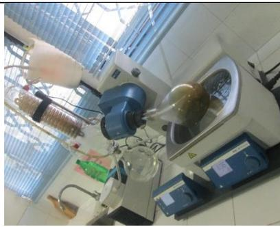
m. Alat *Rotary evaporator* untuk menguapkan etanol
