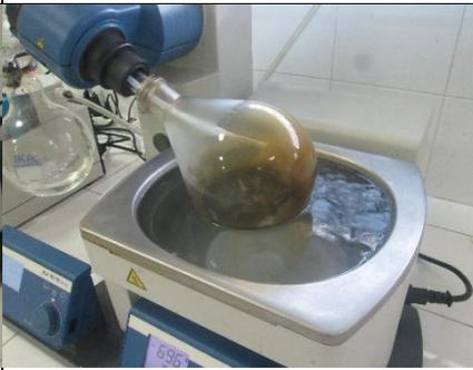
n. Filtrat daun pepaya dievaporasi dalam *rotary evaporator* dengan suhu 6,9-7° C
